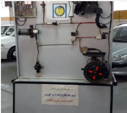
سافت سیستم آموزشی ترمز ضد قفل هیدرولیکی در فودرو
